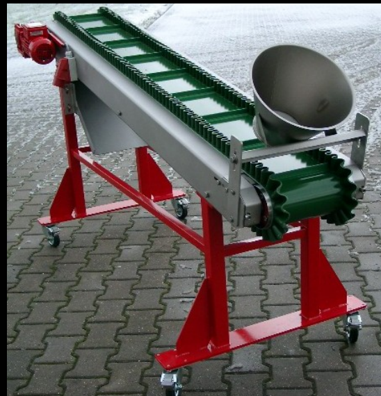
Lamellengurtbandförderer mit eingebauter Bandrolle zur Separierung von Eisenteilen in fahrbarer Ausführung
