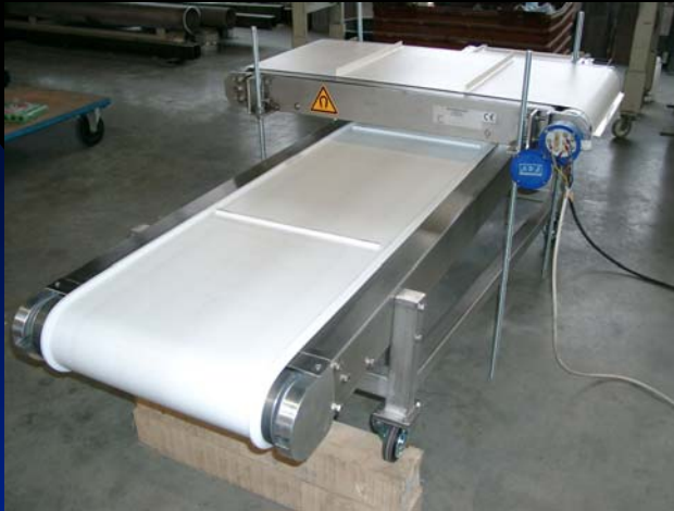
Überbandmagnetförderer mit unmagnetischem Zuführförderer in fahrbarer Ausführung
